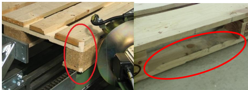
Abbildung 4: 4 Ecken gekappt und 3 Bodenbretter gefast
