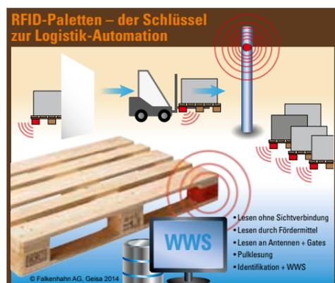
Sind Paletten mit RFID bestückt, genügt eine Vorbeifahrt an den im Bewegungsraum positionierten Antennen oder eine Durchfahrt durch Gates.
